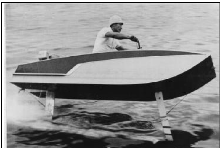
図 8a 一本脚の水中翼船の旋回 (操縦筆者)1954年製作
