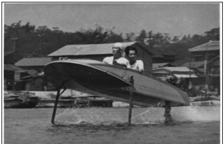
図7 三本脚の水中翼船 操縦筆者。1953年製作
