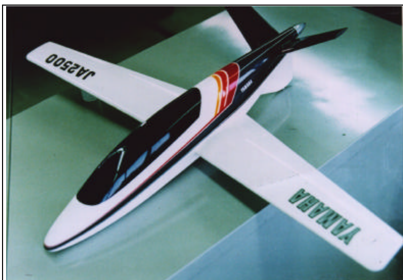
図22 ARV 5.9mL x 6.86mB x 500kg、AR=8.0、90馬力、 L/D_{max}=22.7 、最高速度328km/h、巡航速度300km/h(75% Power)、失速速度99km/h、航続距離4,800km(1人、170km/h)、1993年終焉
