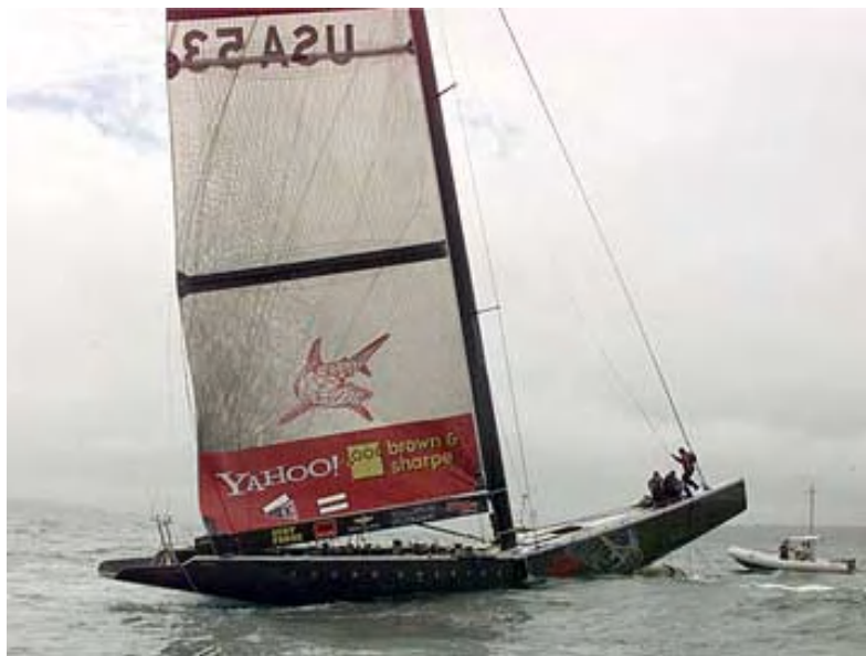
図 5.1.3 二回戦で真二つに折れたヤング・アメリカの USA 5 3 艇
