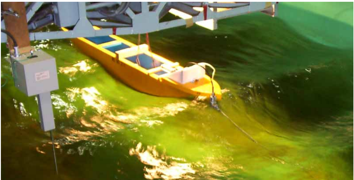
Fig.3.4 係留実験中の写真 (波長1m, 波高12cm)
