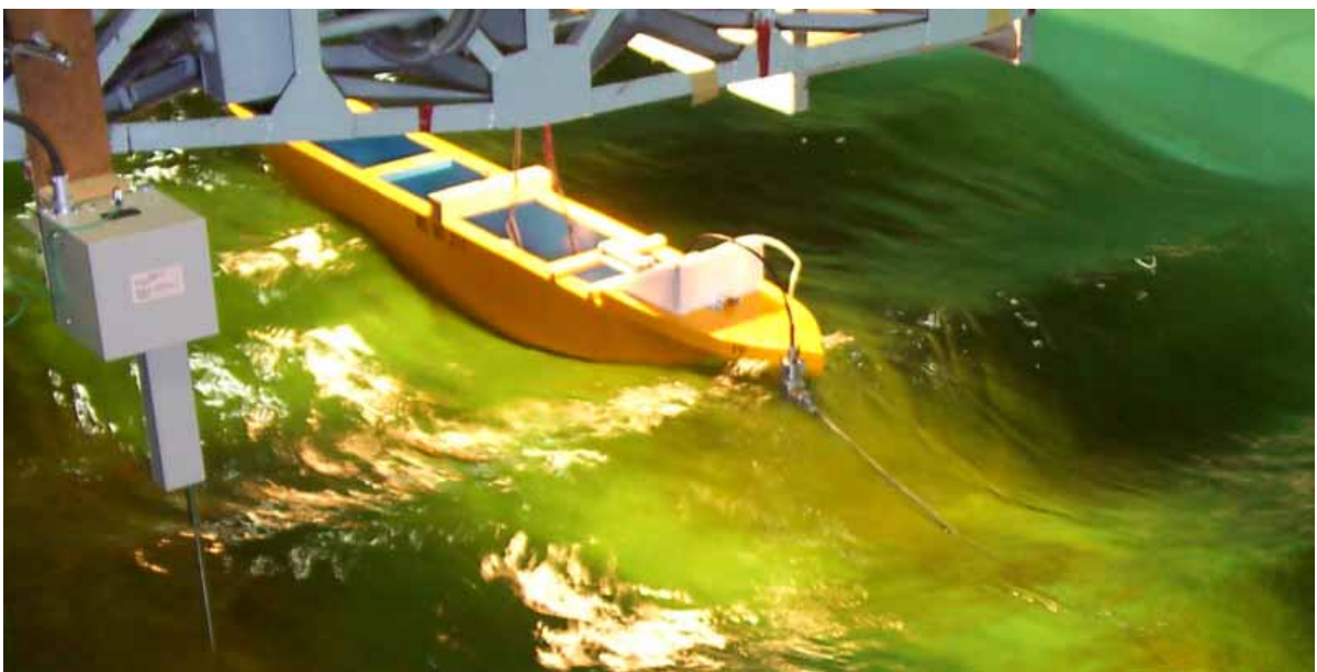
Fig.3.4 係留実験中の写真 (波長1m, 波高12cm)
